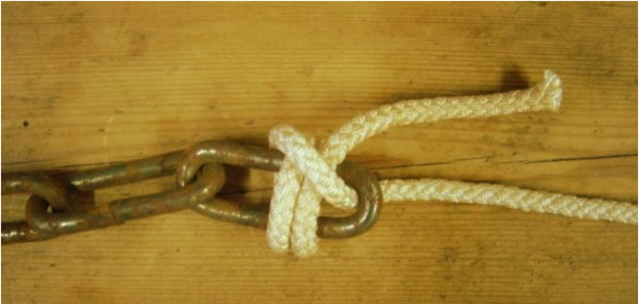
Pilt 7: Topelt soodisõlm ketilüli külge seotuna (sõlm - T.Rajang; pilt - T. Tuulik)
